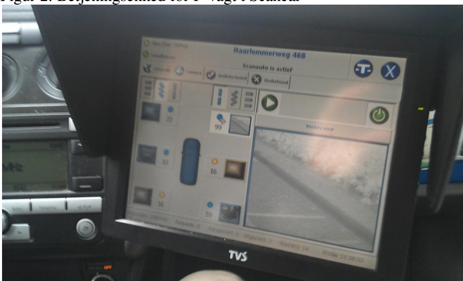
Figur 2: Betjeningsenhed for P-vagt i Scancar
