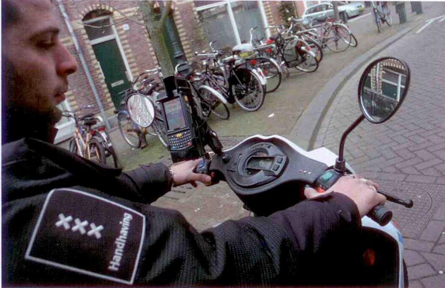
Figur 4: P-vagt på Scanscooter med integreret håndterminal
