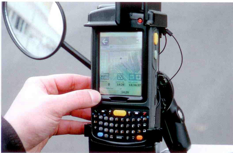
Figur 5: Parkeringskontrol vha. håndterminal med input fra Scancar
