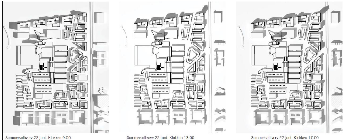
Figur 5-14. Skyggediagrammer. Sommersonhverv 22. juni kl. 9.00, 13.00 og 17.00.
