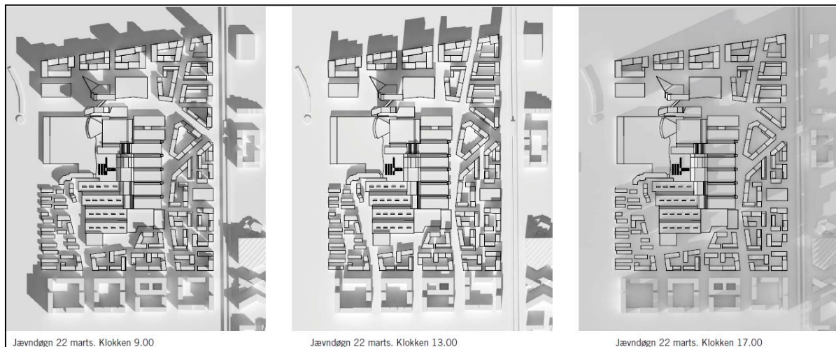
Figur 5-15. Skyggediagrammer. Jævndøgn 22. marts kl. 9.00, 13.00 og 17.00.
