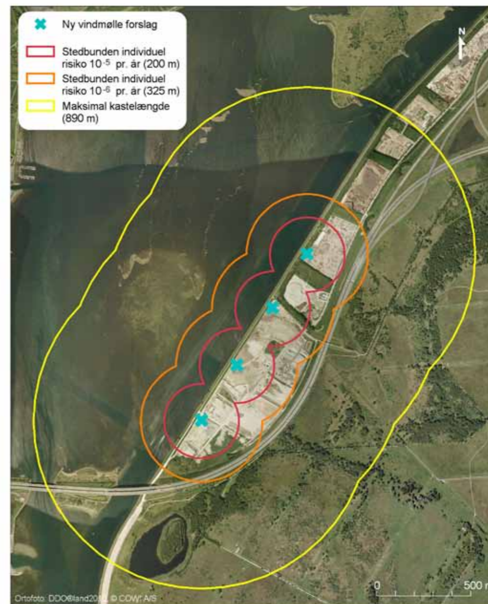
Figur 7.3 Maksimal kastelængde (nedfaldsomsråde) og afstand til stedbunden individuel risiko på 1 \times 10^{-6} pr. år og 1 \times 10^{-5} pr. år for vindmøller på Kalvebod Syd (Alternativ A). Der er ingen forskel i de beregnede kastelængder for de to mølletyper. Alternativ A og B er derfor identiske hvad angår kastelængde.
