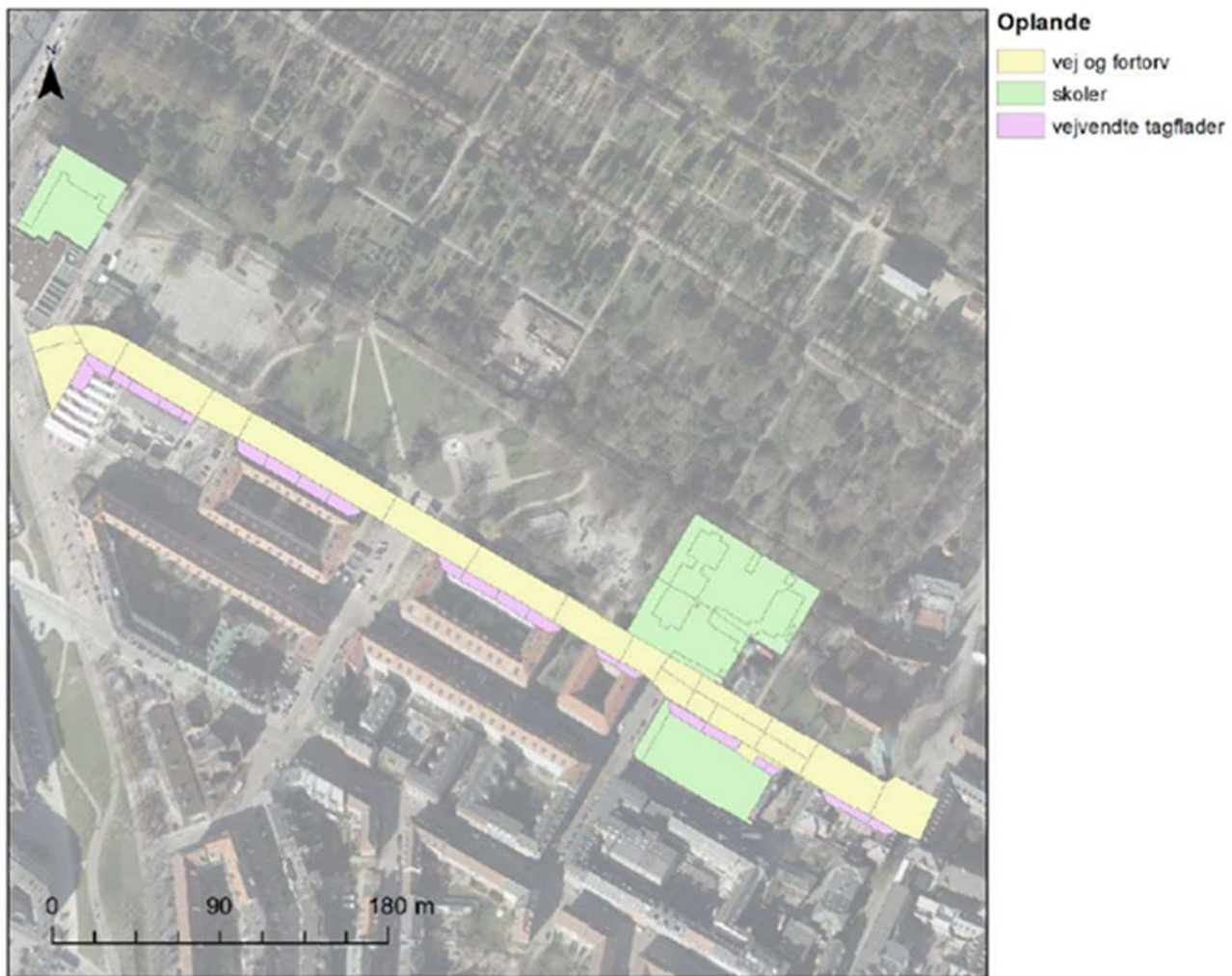
Figur 2: Oversigt over de arealer, der skal afkobles.
