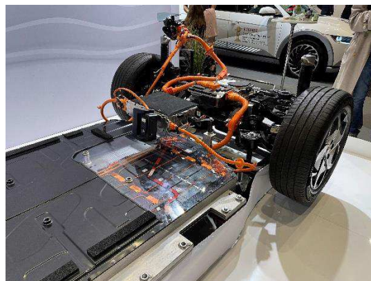
Figur 12: Nyere elbilmodeller har oftest batteripakken liggende i bunden af bilen imellem for- og bagakslen, som det også ses på denne udstillingsmodel (Hyundai).
