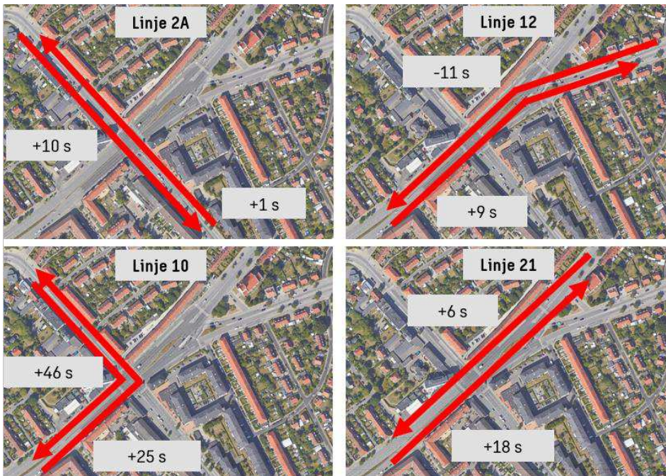
Figur 32. Forskel i busrejsetider, Scenarie 2 optimeret vs. Basis, eftermiddagsspidstid.
