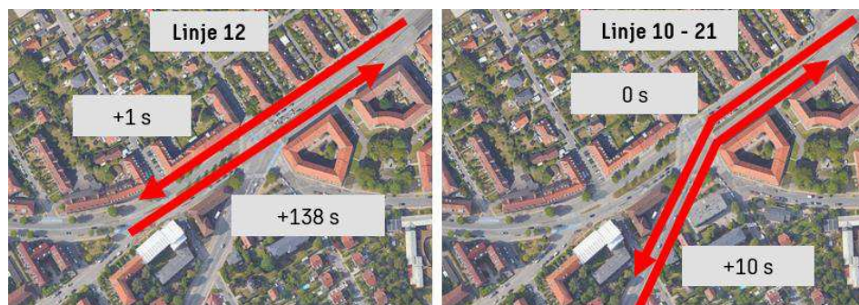
Figur 15. Forskel i busrejsesetider, Scenarie 1 optimeret vs. Basis, eftermiddagsspidstimer.
