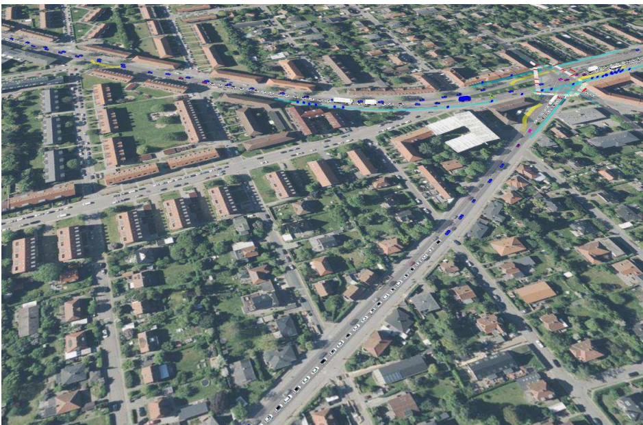
Figur 6. Udtræk fra trafiksimulering: kødannelse på Rebildvej og på Sallingvej vest for krydset ved Rebildvej i morgenspidstimen, Scenarie 2.
