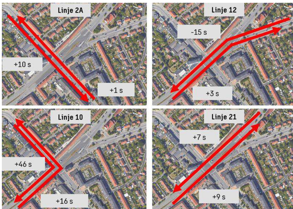
Figur 31. Forskel i busrejsetider, Scenarie 1 optimeret vs. Basis, eftermiddagsspidstime.
