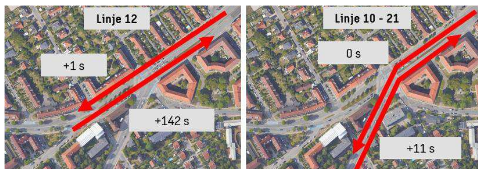
Figur 16. Forskel i busrejsesetider, Scenarie 2 optimeret vs. Basis, eftermiddagsspidstimer.
