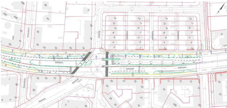
Figur 3. Linje- og afmærkningsplan for grænsefladeprojektet i krydset Sallingvej-Rebildvej, dispositionsforslag.
