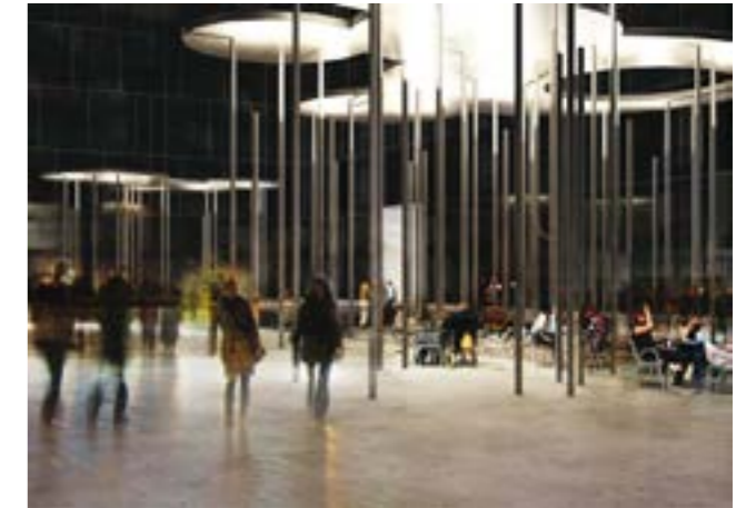
Der etableres to grupper af høje 'sølvtræer' i rustfrit stål og med indbygget lys, som reflekteres ud på pladsen. Træerne giver en poetisk lysætning og understreger en helt særlig stemning på den ellers noget skyggefulde plads.
