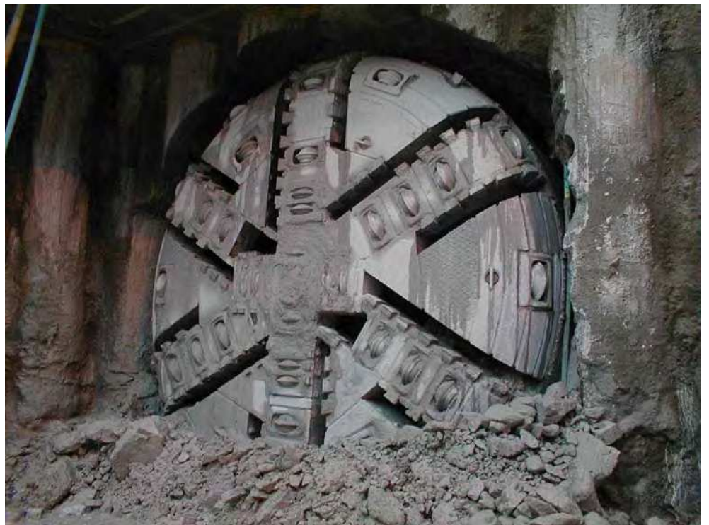
Figur 4.6 Frontskjoldet på en tunnelboremaskine.
