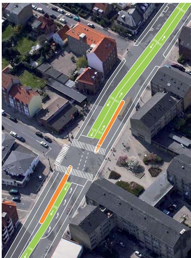
ill. 11: Skitseforslag af den BRT løsningsforslaget ved Havdrupvej. Både i plan ved luftfoto og i tværsnit ved streetview.
