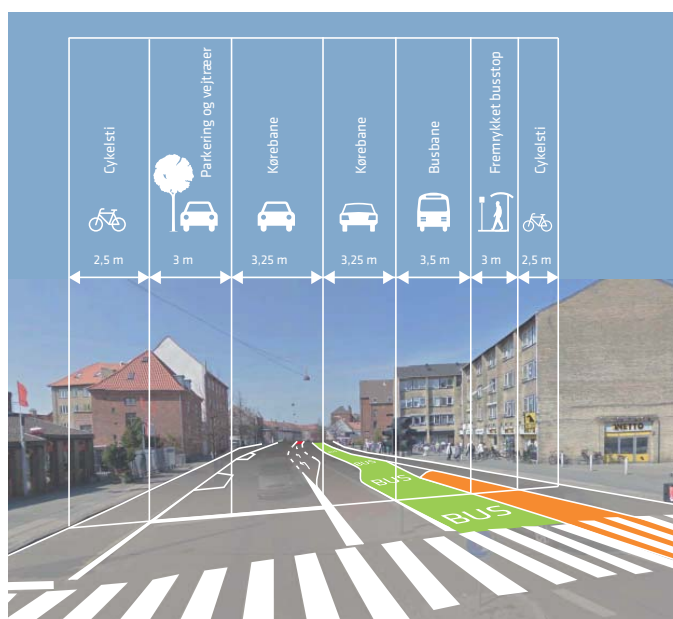
ill. 7: Skitseforslag af løsningsforslaget Traditionel løsning ved Havdrupvej. Både i plan ved luftfoto og i tværsnit ved streetview.
