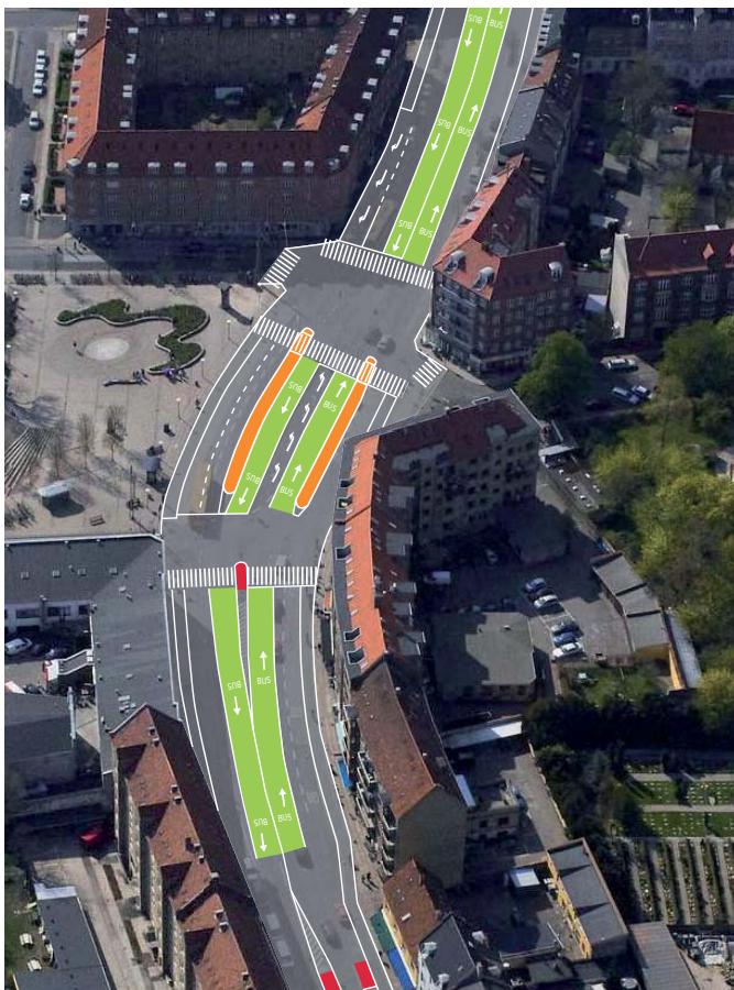
ill. 9: Skitseforslag af BRT løsningsforslaget ved Brønshøj Torv. Både i plan ved luftfoto og i tværsnit ved streetview.
