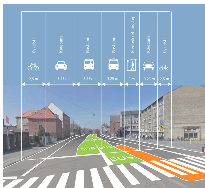
ill. 11: Skitseforslag af den BRT løsningsforslaget ved Havdrupvej. Både i plan ved luftfoto og i tværsnit ved streetview.
