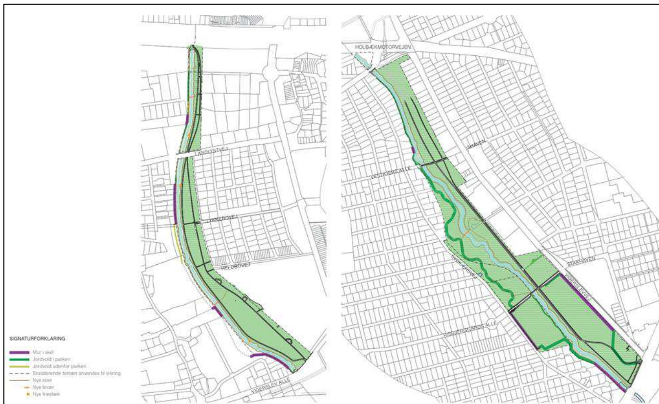
Figur 3-11 Placering af terrænændringer (diger og jordvolde) samt mure til afgrænsning af oversvømmelsesarealer i projektområdet.
