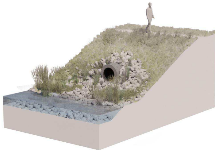
Figur 3-2 Principskitse af justering af Ø700 mm rørudløb til Harrestrup Å på projektstrækningen hvor rørudløbet er placeret i den øverste del af dobbeltprofilet.
