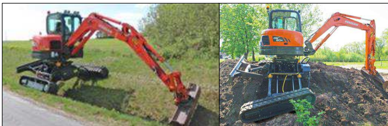
Figur 3-25. Eksempler på specialmaskiner med klippende og forskudte bæltter.
