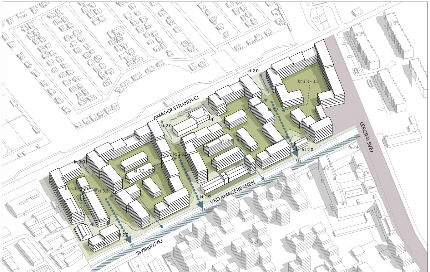
Hævede gårdrum og hiler sender vandet via et skrånende terræn ned til skybrudsvejen i Ved Amagerbanen og i et mindre omfang mod Amager Strandvej. Ill. af Tegnestuon Vandkunsten.
