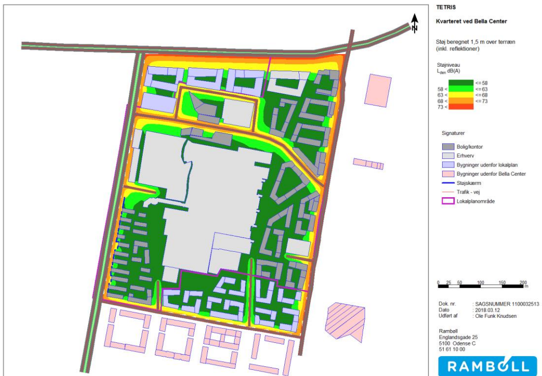
Figur 5-4. Beregnede støjbelastninger på terræn i højden 1,5 m inklusive refleksjoner. Grænseværdi på 58 dB gældende for udendørs opholdsarealer er angivet med den mørkegrønne farve.
