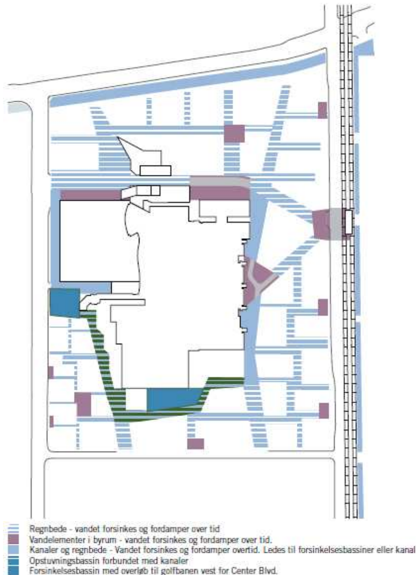
Figur 5-3. Strategi for håndtering af regnvand i Bella Kvarteret. Regnbede anlægges langs veje i området.
