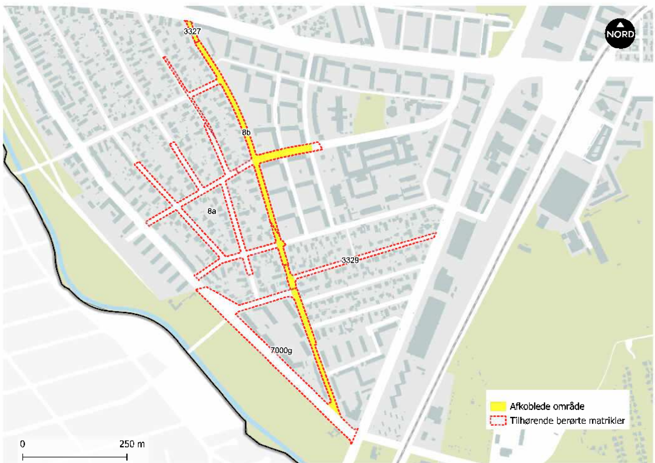
Figur 2: Oversigt over de berørte matriklers arealer, der skal afkobles til vejbede og faskiner
