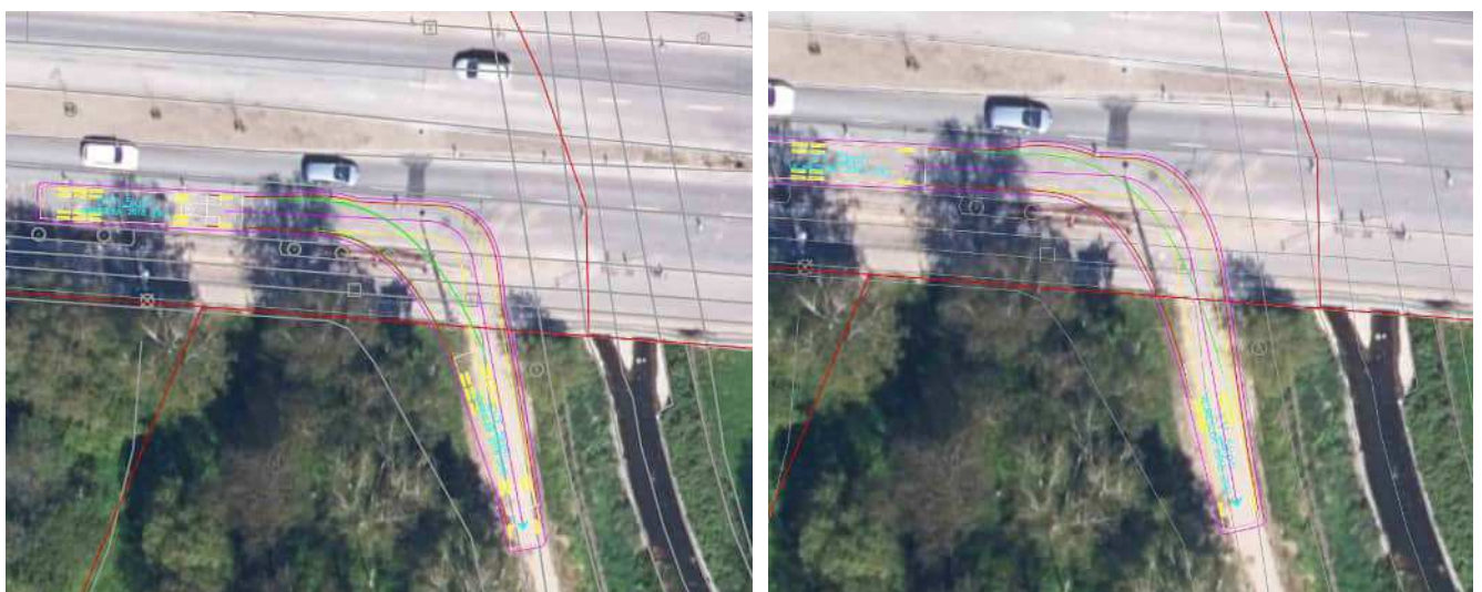
Figur 18. Kørekurver for højresvinget ind på arbejdsvejen kommende fra Jyllingevej med hhv. en sættevogn (tv.) og en lastbil (th.)
