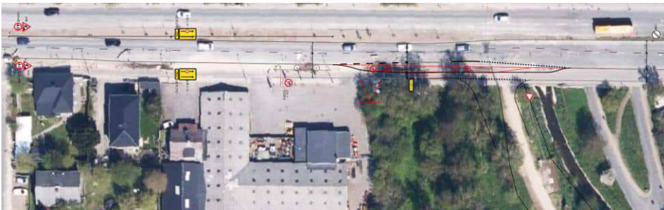
Figur 6: Tiltag til forbedring trafiksikkerheden ifm. arbejdskøretøjernes højresving ind og ud fra arbejdsvejen.
