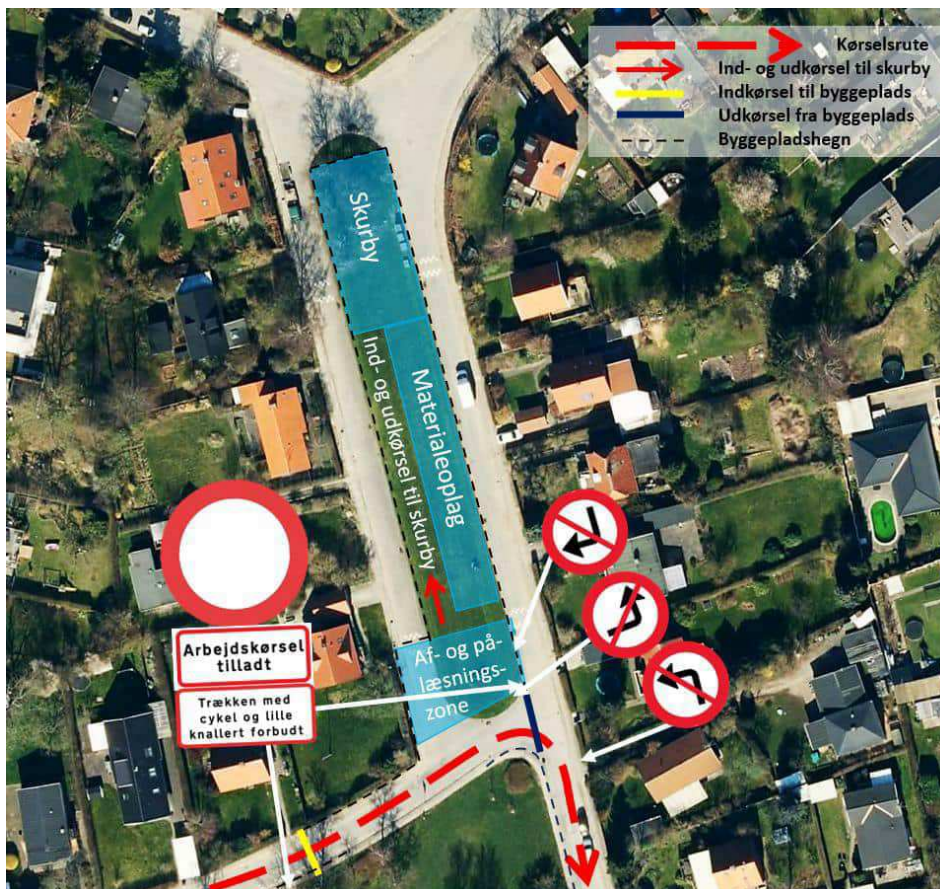
Figur 4: Byggeplads, samt vejlukning på Åvendingen.
