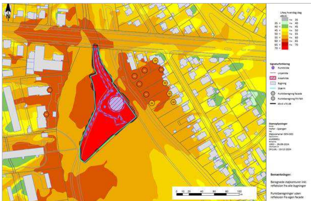
Figur 11-14 DEN resultater, hverdage 8:00-17:00. Nedbrydning af toppen af beton på slidsevæggene, så der kan arbejdes videre med armeringen I samme fase etableres jordankre fra et niveau der forventes beliggende ca. 2 meter under nuværende terræn. Det vurderes, at støjen indeholder tydeligt hørbare impulser. Dermed skal der gives 5 dB impulstillæg, dvs. at 70 dB støjbelastning overstiges ved L_{Aeq} = 65 dB(A)
