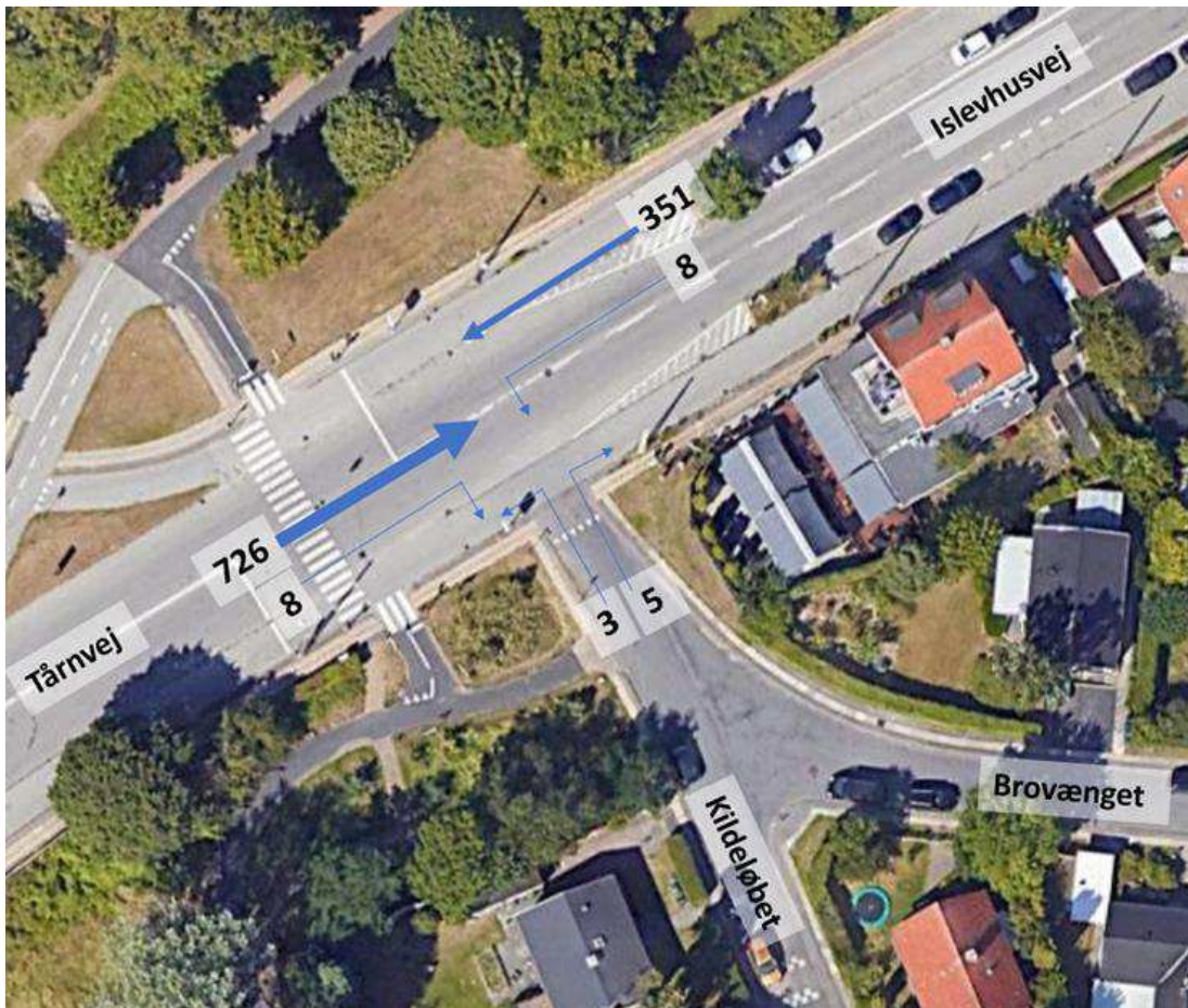
Figur 10-17 Svingbevægelser i morgenspidstimen i anlægsperioden. Trafikken indeholder både eksisterende trafik og anlægstrafikken.
