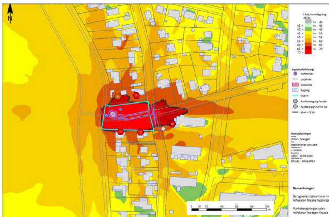
Figur 11-21 DES resultater, dag 8:00-17:00 Nedbrydning af toppen af beton på slidsevæggene, så der kan arbejdes videre med armeringen. I samme fase etableres jordankre fra et niveau der forventes beliggende ca. 2 meter under nuværende terræn. Det vurderes, at støjen indeholder tydeligt hørbare impulser. Dermed skal gives 5 dB impulstillæg, dvs. at 70 dB støjbelastning, L_r overstiges ved L_{Aeq} = 65 dB(A).
