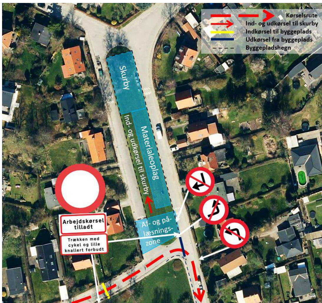
Figur 10-26 Adgangsforhold til byggeplads.
