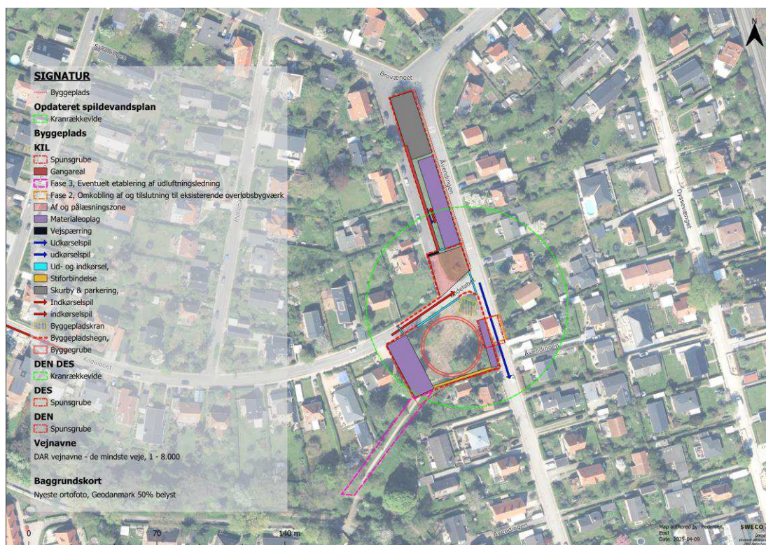
Figur 19-6 Byggepladsindretning ved KIL.
