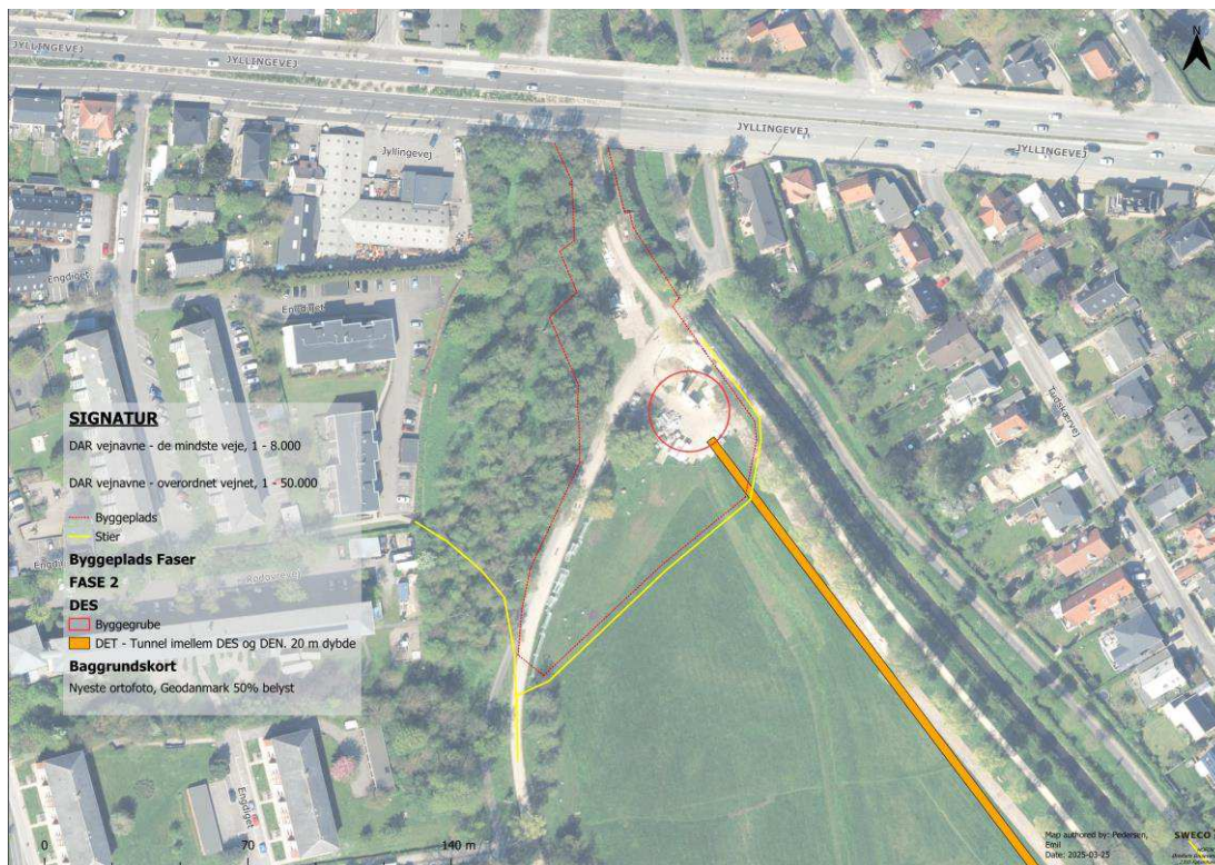
Figur 9-2 Midlertidigt stiforløb (markeret med gul) ved DEN under anlægsfasen.
