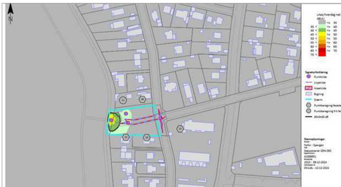
Figur 11-19 DES resultater, aften- og natperioderne. Grundscenarie. Der gives ikke impulstillæg, dvs. 40 dB støjbelastning overstiges, når L_{Aeq} er over 40 dB
