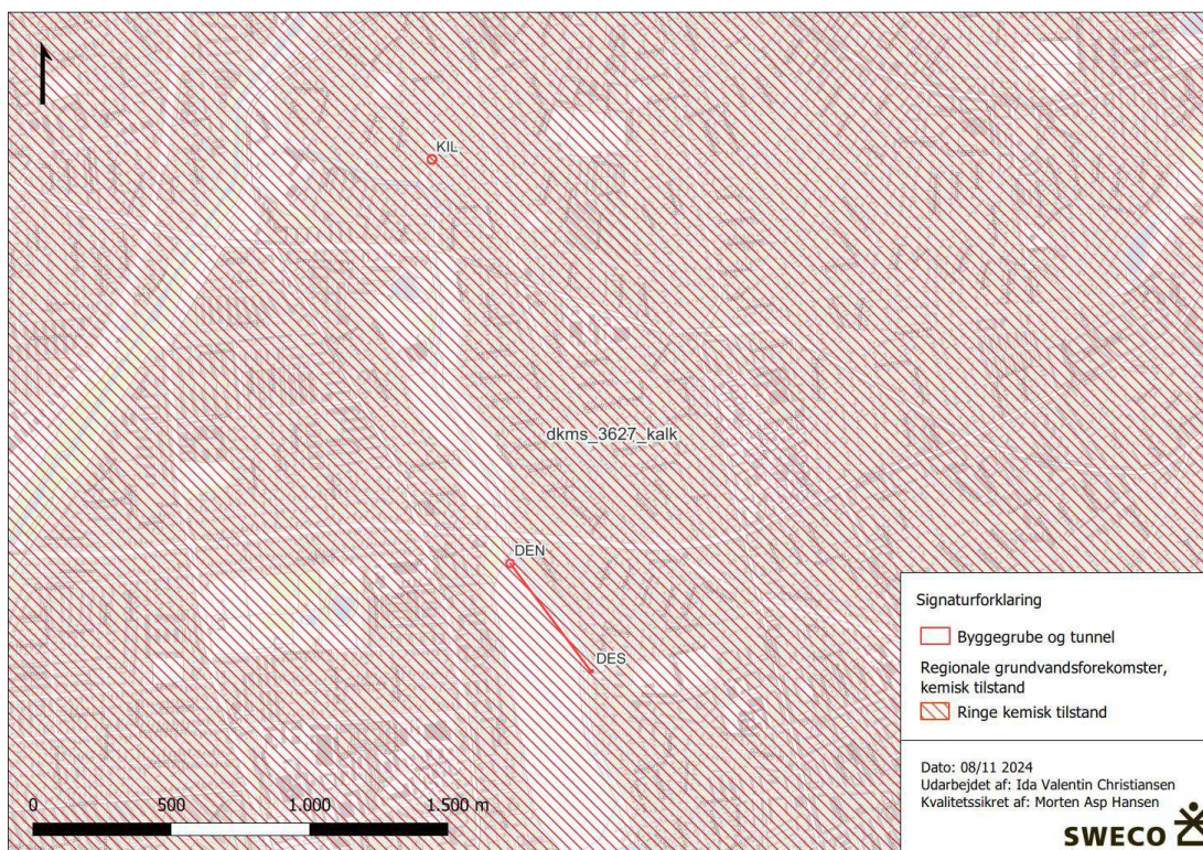
Figur 18-6. Regionale grundvandsforekomster ved projektområdet, kemisk tilstand. Byggegruberne ved DES, DET og KIL er markeret med røde cirkler. Tunnellen, DET, fremgår som en rød streg, der forbinder DES og DEN.
