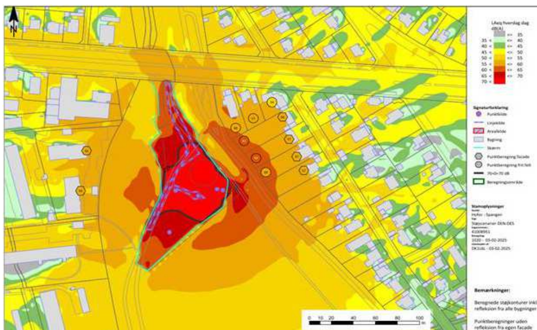
Figur 11-16 DEN resultater, hverdage 7:00-18:00 samt lørdage 7:00-14:00. Tunellering. Der gives ikke impulstillæg, dvs. 70 dB støjbelastning overstiges, når L_{Aeq} er 70 dB.
