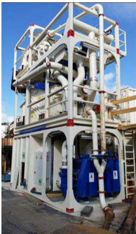
Figur 4-9 Separationsanlæg til slurry fra tunnelboremaskinen (uden afskærmning)
