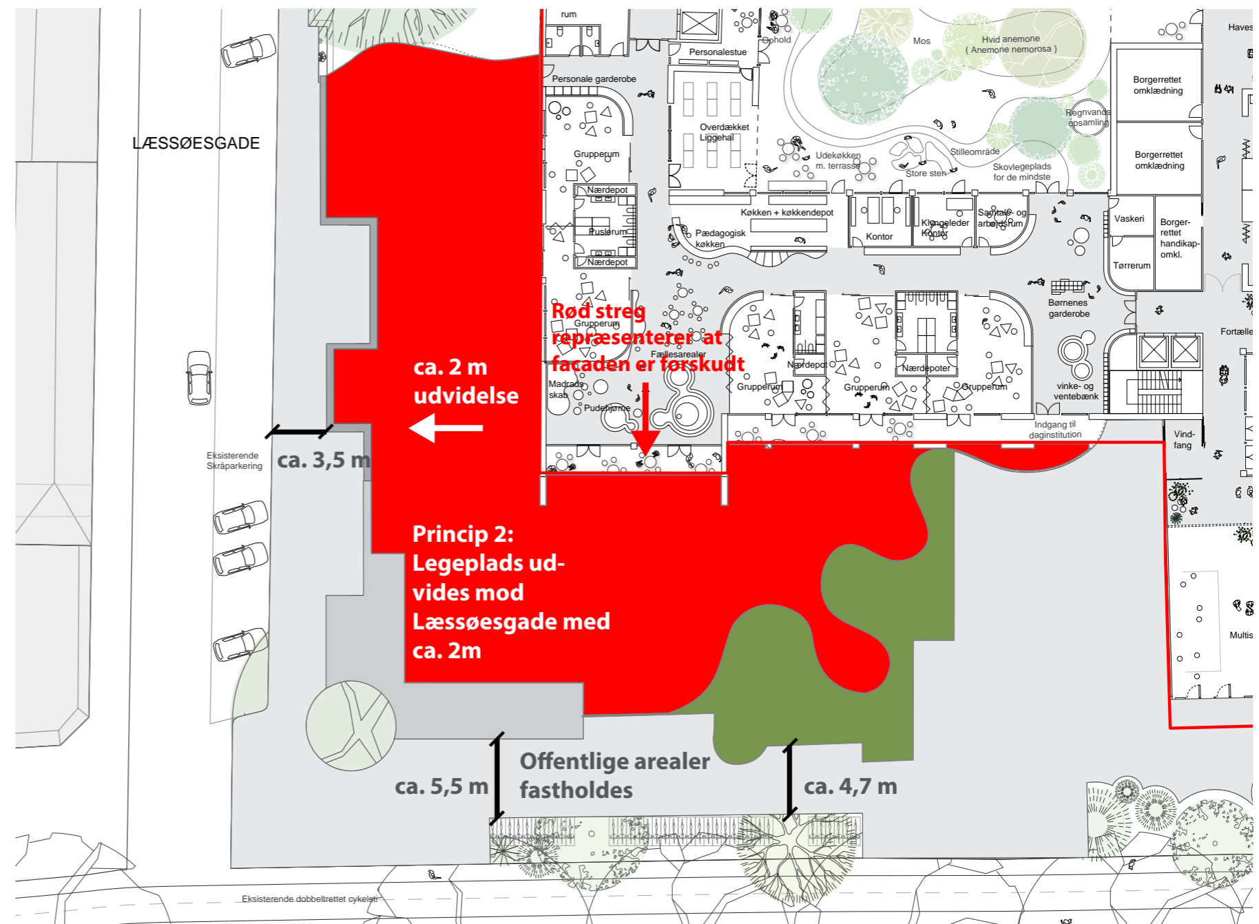
▲ Princip 2. Forskydning af bygning 2 m mod søerne og udvidelse af legeplads mod Læssøesgade også ca. 2m. Legepladsens areal mod søerne vil blive reduceret tilsvarende bygningens forskydning. Det samlede areale vil blive bevaret pga. udvidelsen mod Læssøesgade.
