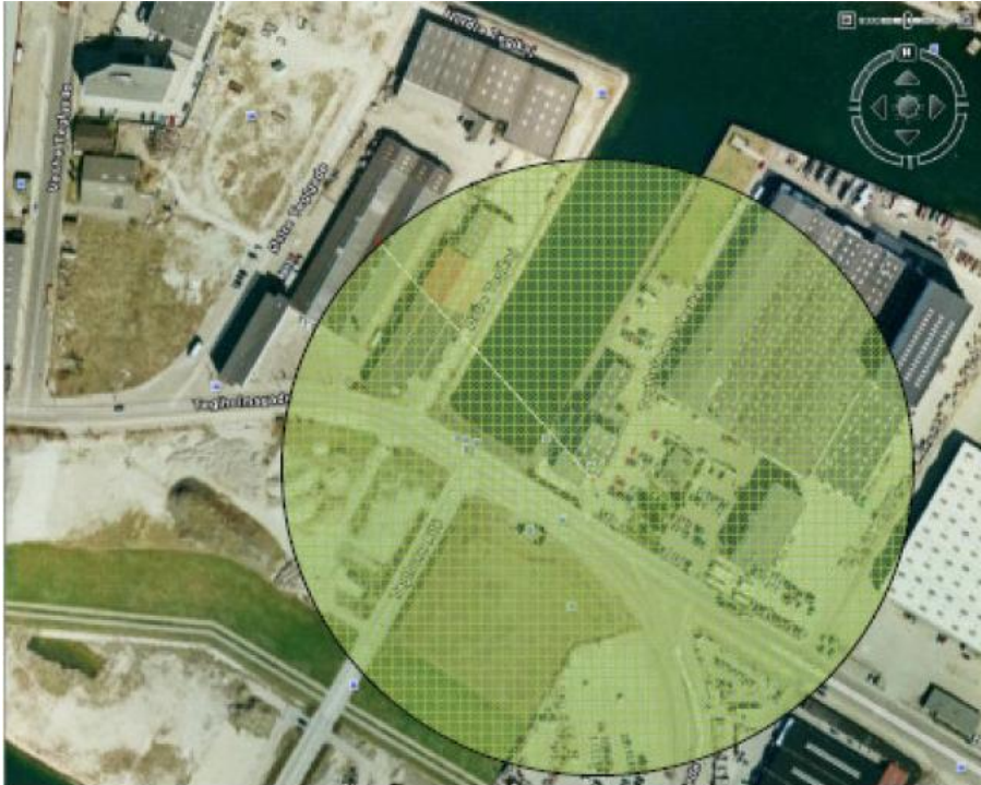
Figur 2- Beregnet konsekvensområde for indendørs kombineret luft- og strukturlydniveau L_{pA,LF} = 20 dB i 20 m høj bygning. Grænseværdiafstand ca. 150 m. Dæmpet skorstensafkast.
