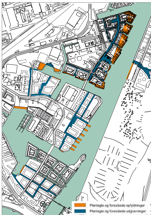
Opfyld og udgravning i Sydhavnen. På Enghave Brygge afgraves ca. 30.000 m 2 og opfyldes ca. 35.000 m 2 .
