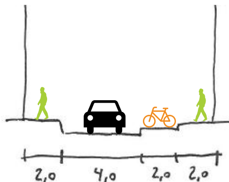
Principsnit AA for modstrømscykelsti.
