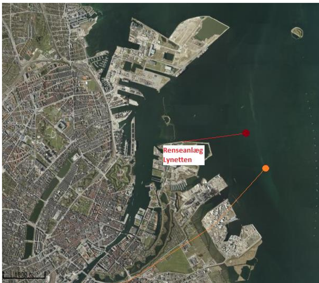
Figur 3 Oversigtskort over Renseanlæg Lynettens beliggenhed, udløbsledning (rød streg) og udløbspunkt (rød prik – UTM Euref 89; 728.971, 6.178.614). Renseanlæg Damhusåen udleder ca. 1,1 km derfra (orange prik).
