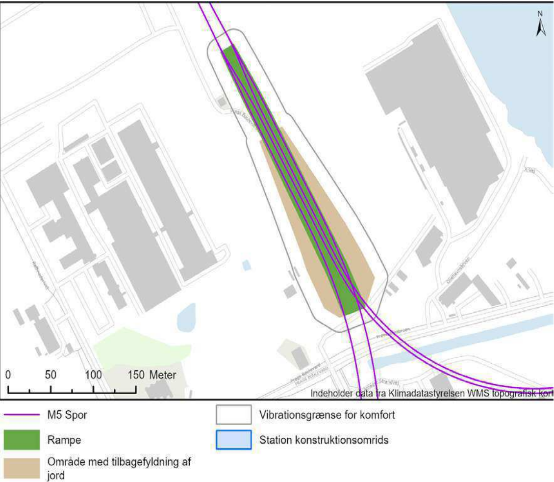
Figur B.22 Vibrationskort for vibrationskomfort ved etablering af rampe ved forgravning og nedvibrering af spuns ved Prags Boulevard (Prb).
