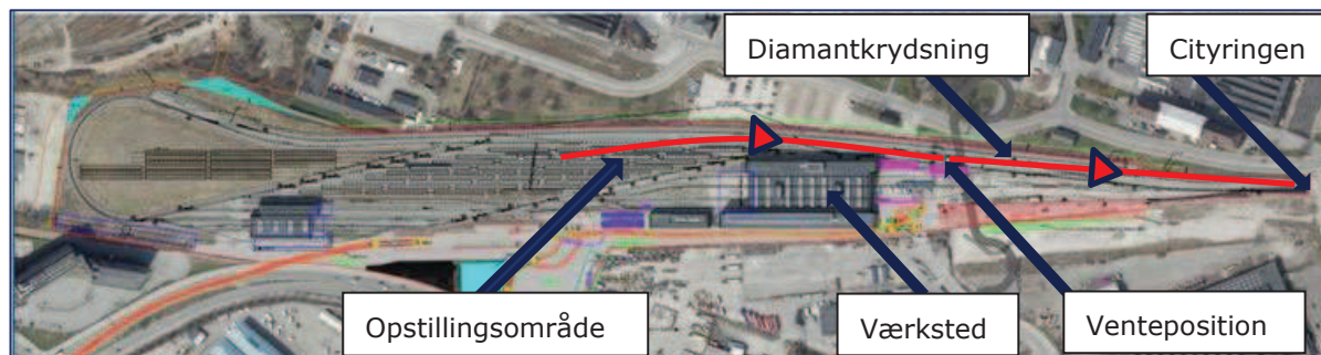
Figur 8-2. Udkørsel til Cityringen foregår fra opstillingsområde med 15 km/t til venteposition nordøst for værksted. Derefter køres der gennem diamantkrydsningen og videre ind på Cityringen med 40 km/t.
