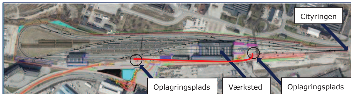
Figur 8-7. Gaffeltruck kører frem og tilbage mellem oplagingsplads nordøst for værksted til oplagingsplads sydvest for værksted med 15 km/t.
