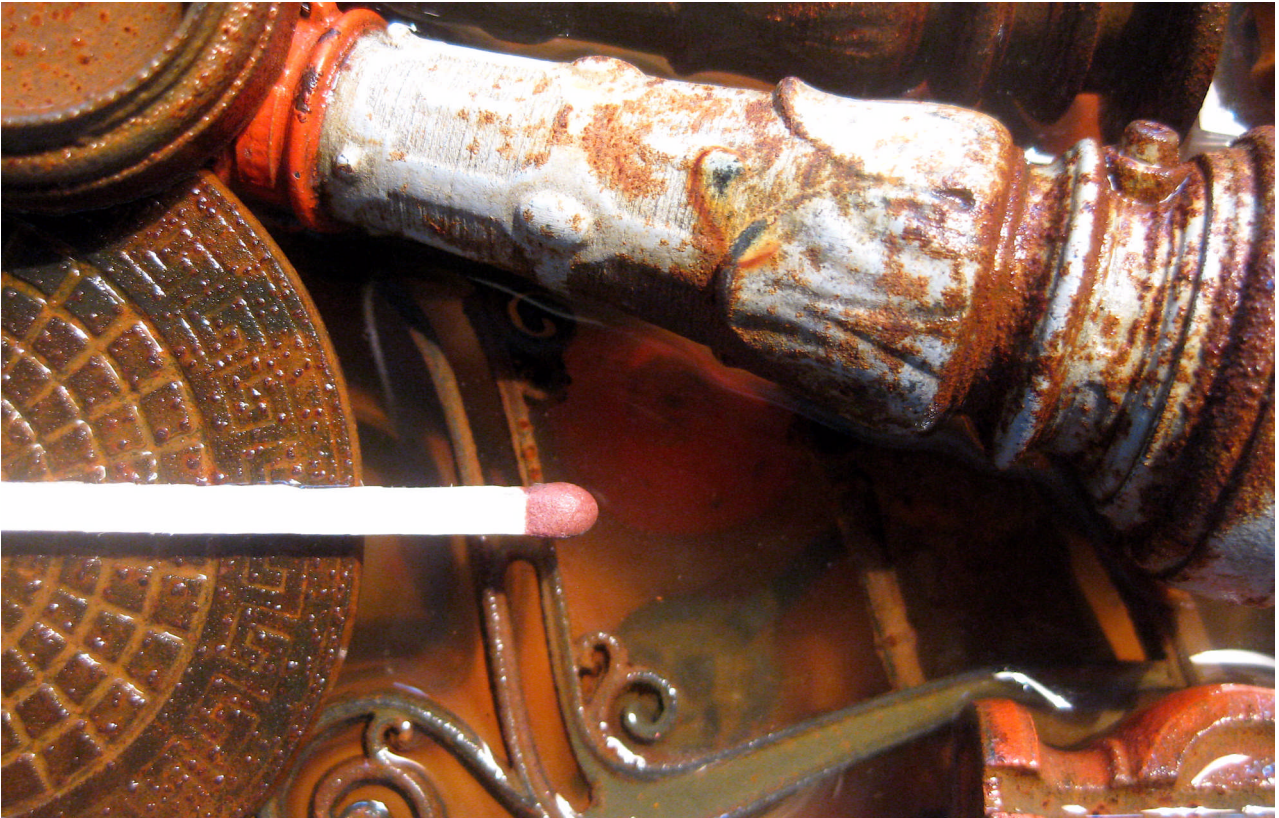
Afstøbningsteknikken (VAC) og materiale sammensætningen muliggør korrosion af de støbte emner
