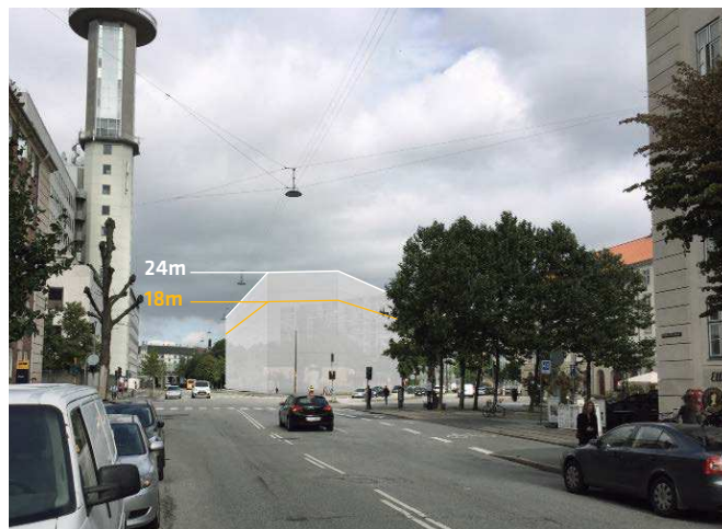
Volumenstudie visende højdegrænse af bebyggelse på hjørnet i henholdsvis 18 og 24 meter svarende til henholdsvis 5 og 7 etager, inklusive en høj stueetage til butik. Den endelige disponering af bebyggelsen vil ske i den videre projektudvikling under hensyn til de nævnte anbefalinger. Illustration COBE
