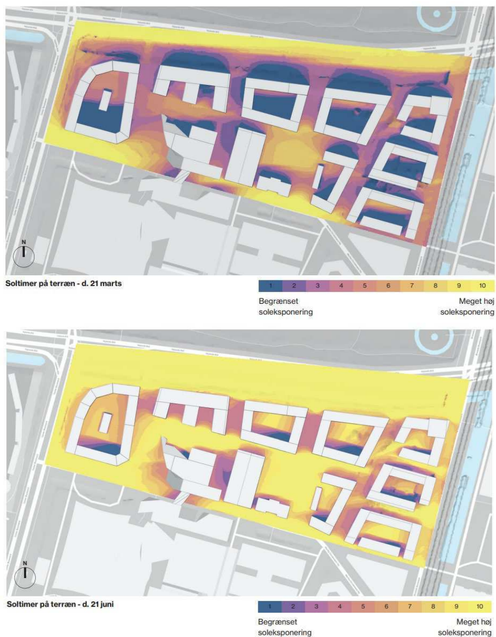
Figur 9-3, Sollysforhold, soleksponering hhv. d. 21. marts og d. 21. juni. Inkl. Bygningsfelternes (BF) numre fra Bilag 4.
