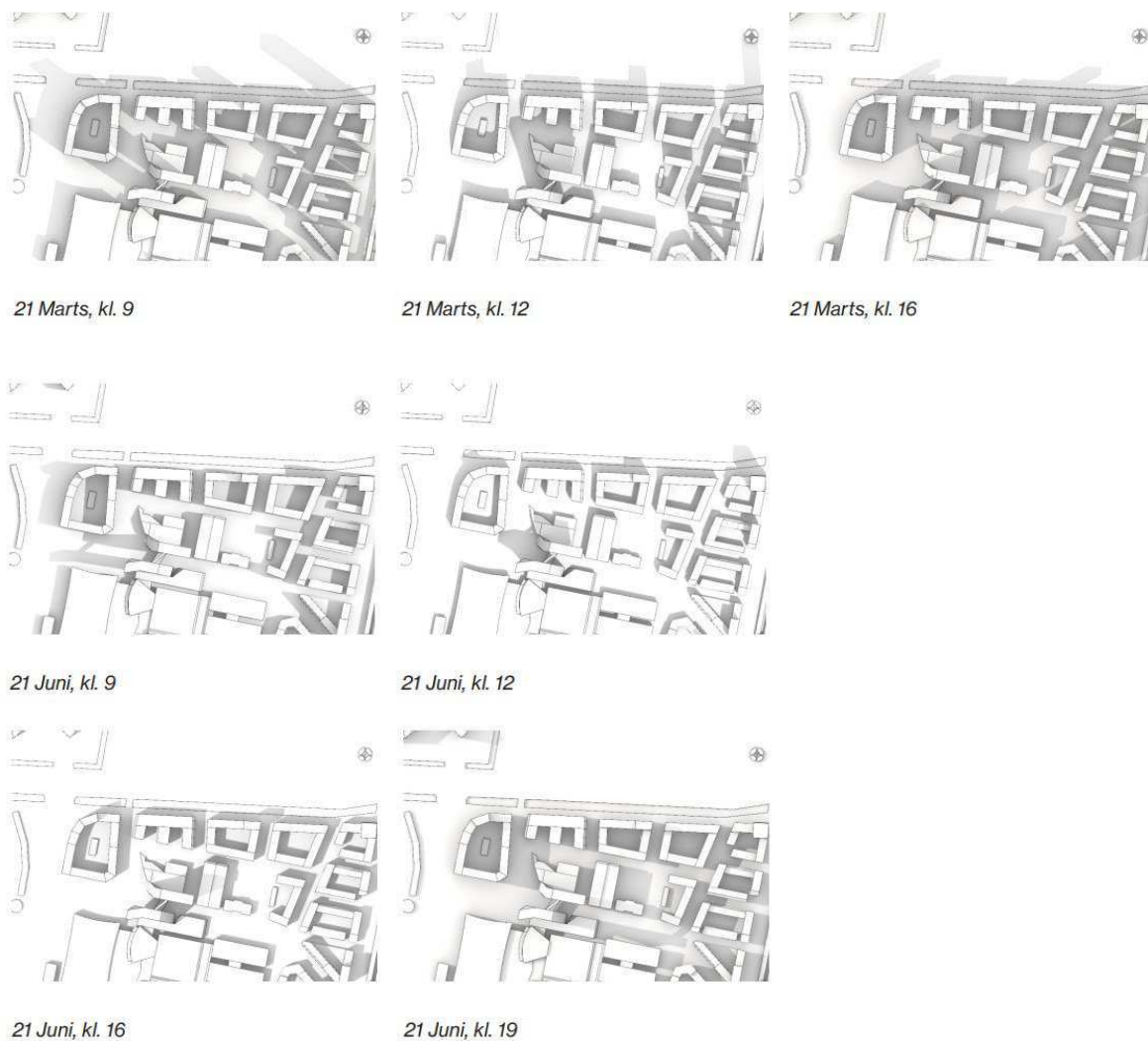
Figur 9-2, Skyggediagrammer for planlagt bebyggelse hhv. d. 21. marts og 21. juni
