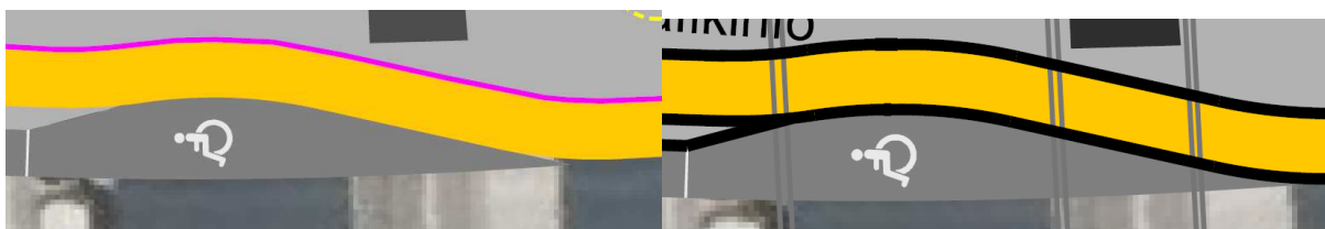
Figur 1. Udsnit fra løsningsforslag 3 (tv) og samme udsnit fra løsningsforslag 2 (th). Kantstensbegrænsning er ud fra signaturen fjernet, hvilket ikke giver mening.
