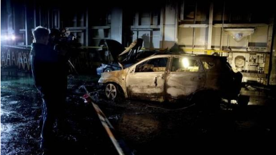
Brand i el-bil (ombygget Nissan Qashqai) under opladning på Oslo færgeren i 2010 (Brandårsag uoriginal ledning)
