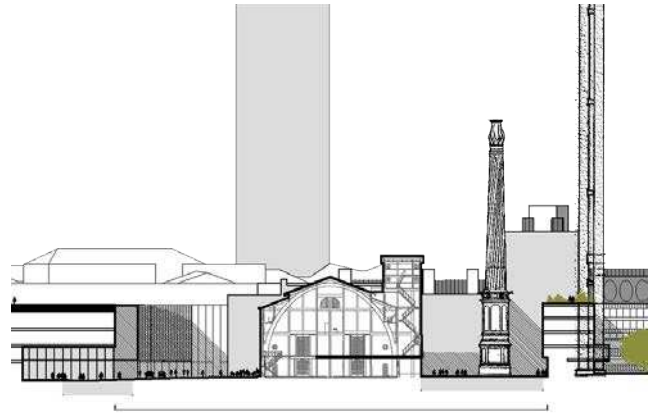
Snit gennem Franciska Clausens Plads og Kedelhuset viser den sydlige del af pladsen til venstre og den nordlige del af pladsen til højre. Bebyggeseshøjden er siden øget på de omkringliggende byggerier.
