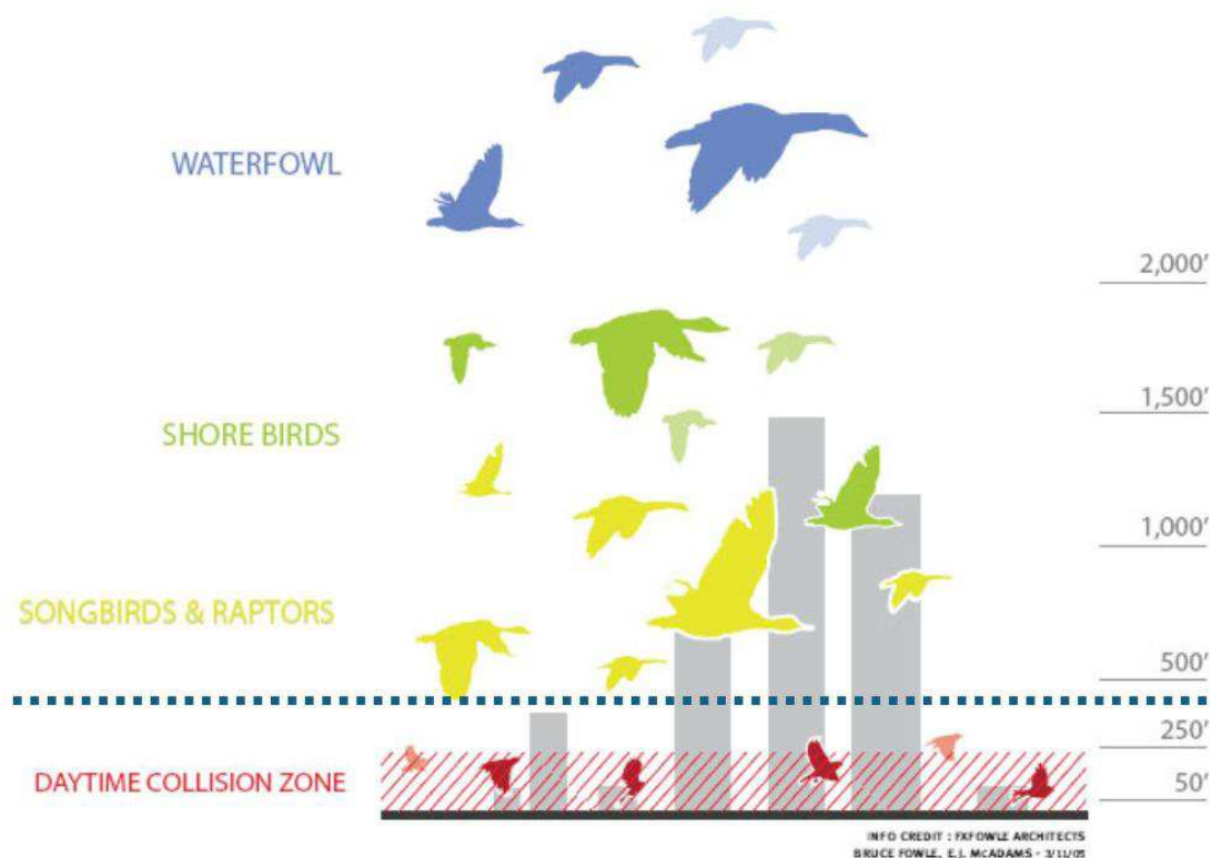
Figur 7-1. Forskellige fuglegrupperes trækhøjde sammenlignet med nutidens højhuse. Skalaen til højre er i fod. Den maksimale højde af det planlagte byggeri på Langelinie er ca. 390 fod (1 fod = 30,5 cm). Denne højde er markeret med stiple, vandret linje på figuren. (New York City Audubon Society, 2007)
