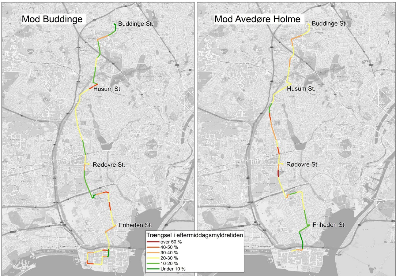
Figur 8 Hastighedsnedsættelse på linje 200S i eftermiddagsmyldretiden målt ift. kørsel uden trængsel. (Datakilde: Movias GPS registreringer, 2018).
