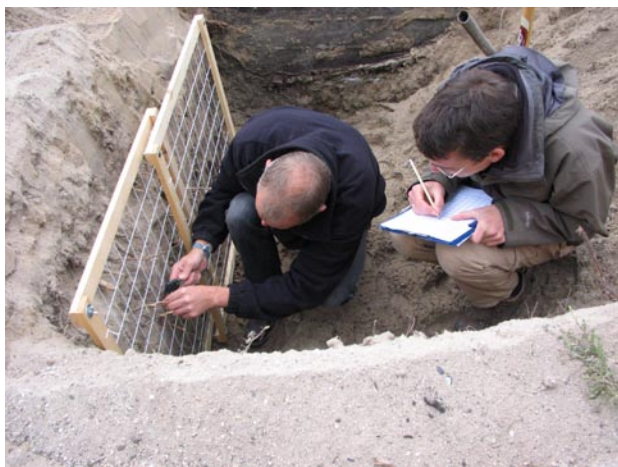
Figur 48: Måling af røddernes tværsnitsareal ved hjælp af målerammer og elektronisk skydelære.
