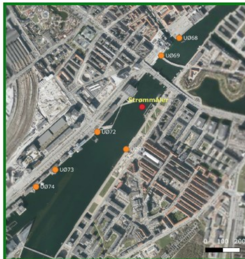
Figur 2-1 Udløb fra overløbsbygværker omkring Havnebadet Islands Brygge.
