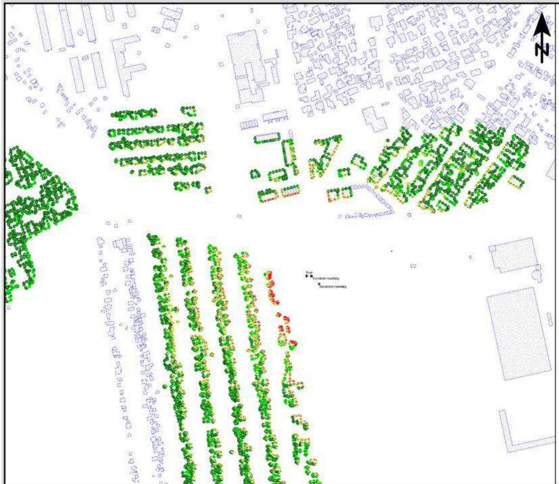
Figur 9.25 Støj fra anlægsarbejder i byggefase 6b for byggepladsen ved Enghave Kanal, ved drift af tunnelarbejdspladsen (slurry-metoden) om natten forudsat maksimal støjdempling af kran og separationsanlæg. Tunnelering med EPB viser samme støjdbredelse. Haveforeningen Musikbyen er ikke godkendt til overnatning (samme situation som i Figur 9.24).
