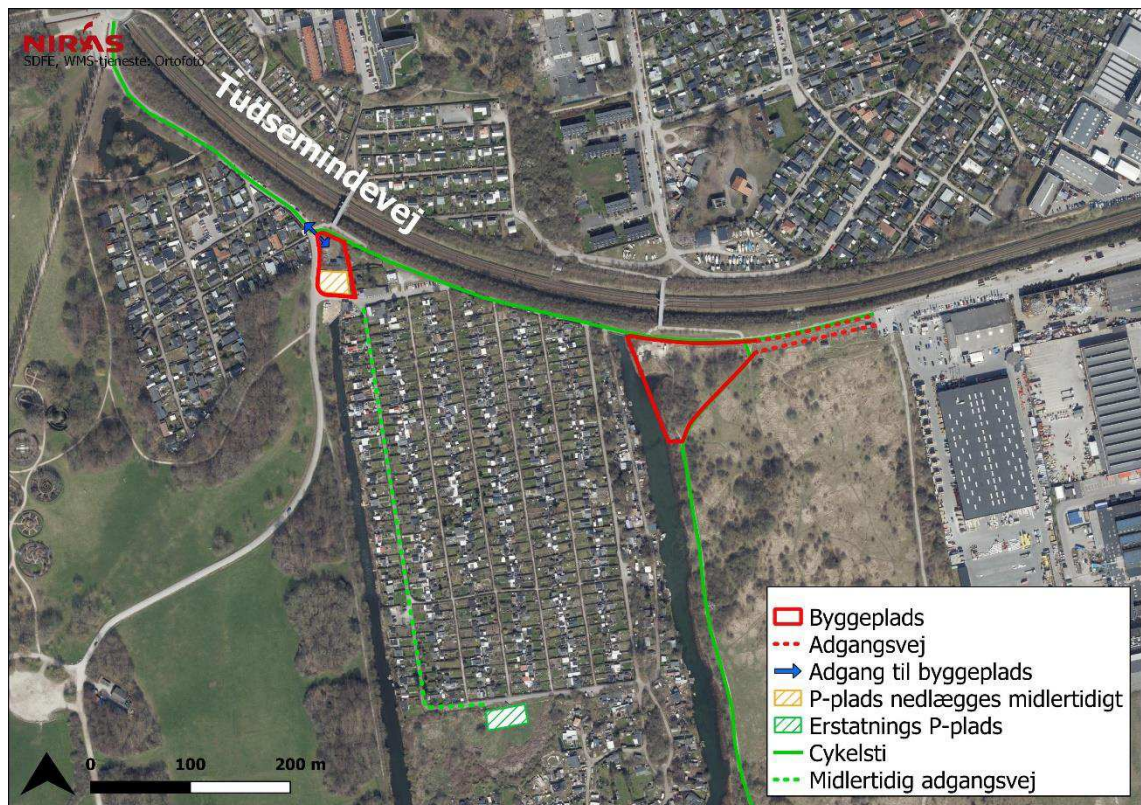
Figur 8.10 Byggeplads for skakt ved Musikbyen med adgang for tung trafik og forslag til placering af erstatnings p-pladser.
