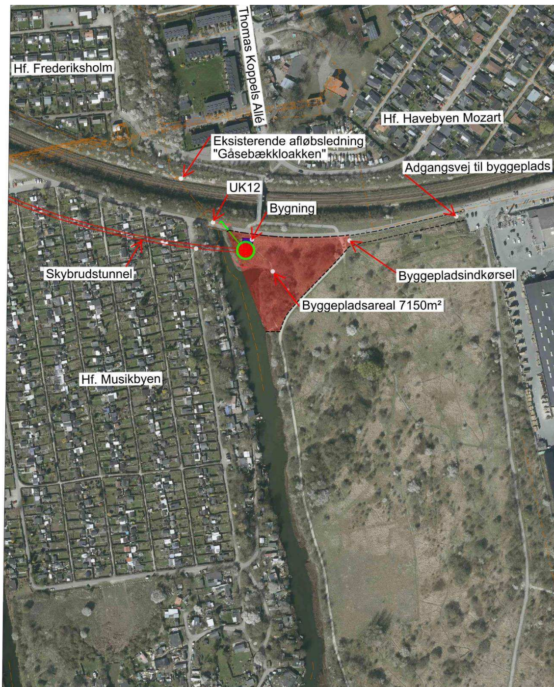
Figur 5.5 Byggeplads ved Enghave Kanal med placering af den dybe skakt og udløbsbygværket.
