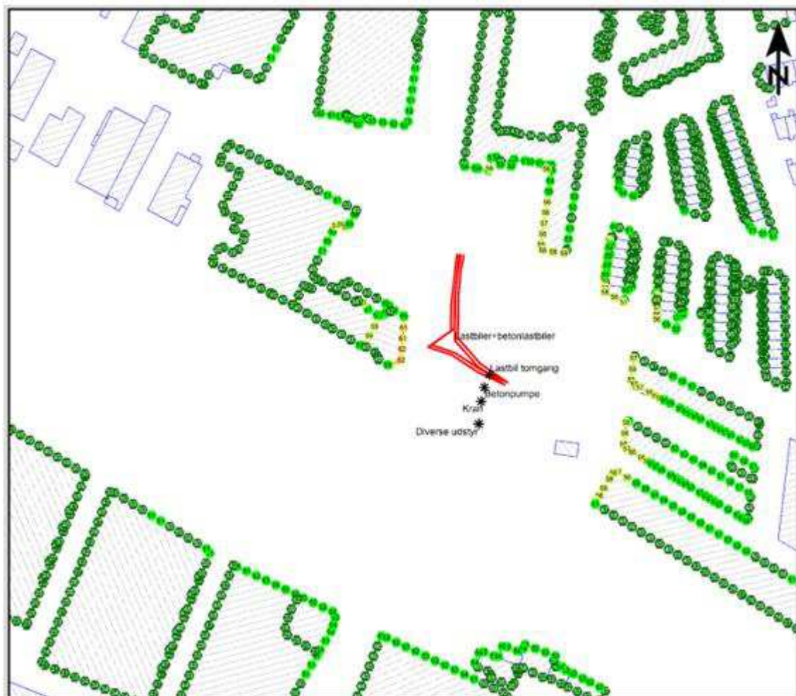
Figur 9.5: Støj fra anlægsarbejder i byggefase 7 for byggepladsen ved FLSmidt, støbning og færdiggørelse af skakt. Støjkortet medtager ikke tillæg for hørbare impulser på 5 dB.
