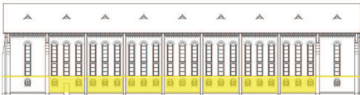
Den tunge del af facaden med "borggittervinduerne"
