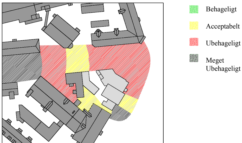
Figur 6.7. Illustration af vindmiljøet ved eksisterende bygninger på Jagtvej 171 ved aktiviteten ”stå eller sidde i længere tid”.
