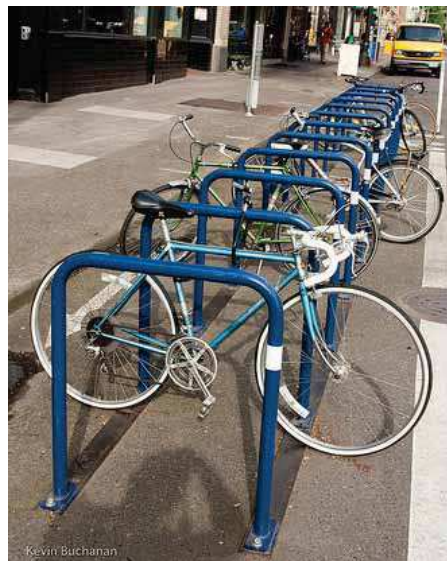
Cykelstativer hvor man kan låse selve stellet, den typisk dyreste del på cyklen, fremfor at kunne låse hjulet fast, om noget overhovedet.
