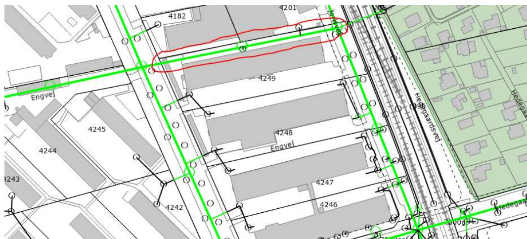
Figur 1 Markering af omtalte spildevandsledning – rød markering
