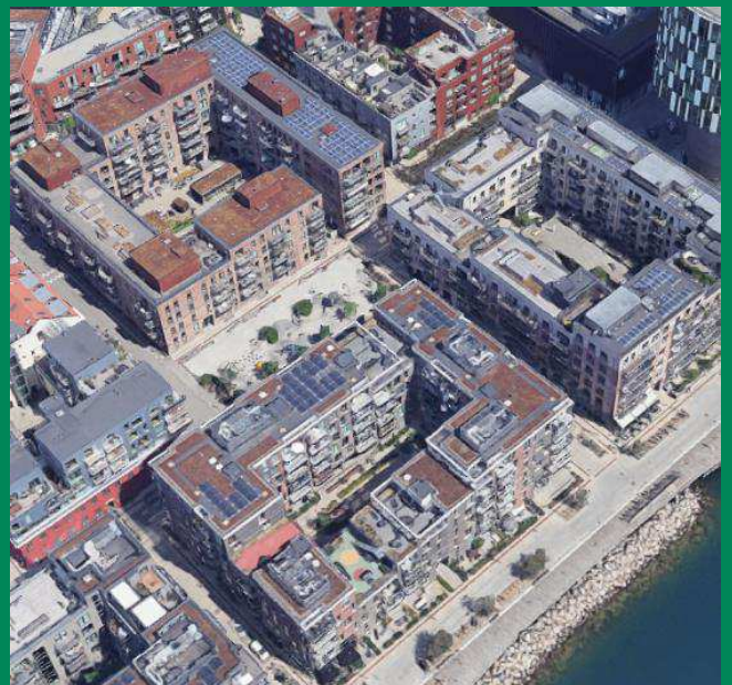
De nye bykvarterer. Fra 2000 og frem. 5-9 etager. 10-12 m dybe + altaner. Varierende størrelser. Flade tage, Springende højder. Bygget på én gang.
