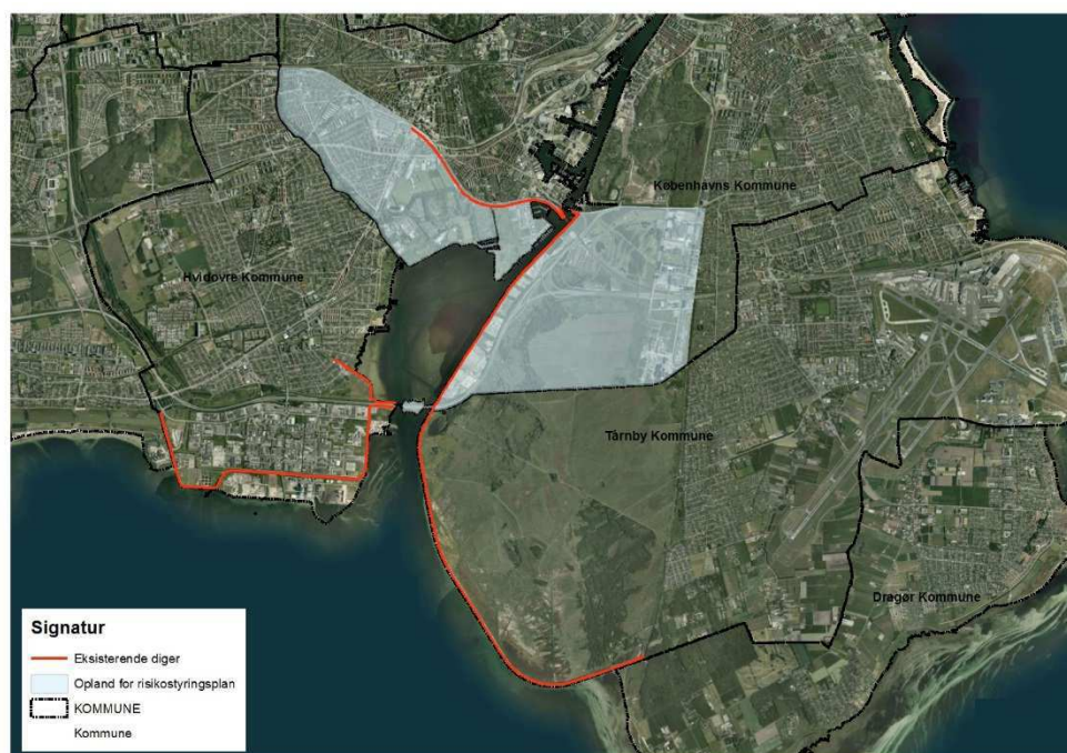
Figur 3: Eksisterende stormflodsbeskyttelse i Kalveboderne.
