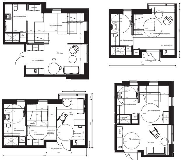
Udvalg af plantegninger der viser projektets plejeboliger. 68 x torums boliger. 17 boliger pr. boligetage. 12 x etrumms boliger. 3 boliger pr. boligetage.
