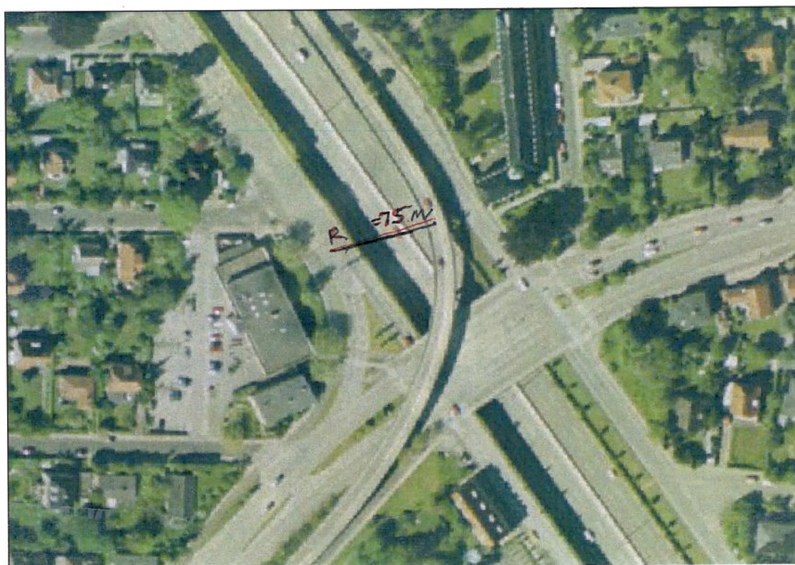
Tilslutning fra Tuborgvej til Lyngbyvej: Minimumradius 75m
