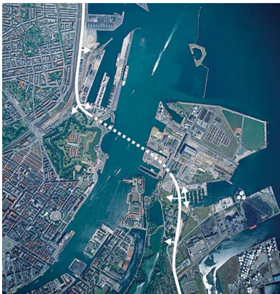
Linjeføring for kort sænketunnel med tilslutningsanlæg
