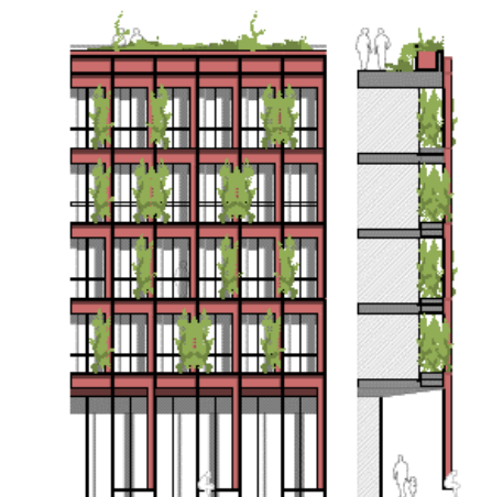
Bygherres foreløbige forslag til hvorledes plantekasser kan integreres i facaden og skabe mulighed for begrønning. Der etableres også begrønning på tagterrasser evt. som plantekasser mod byrum. Mod Florsgade og Hiort Lorenzens Gade trækkes værnnet tilbage, og der etableres plantekasser mod gaderne. Illustration entasis.
