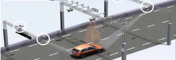
FIGUR 3.10 Funktion af betalingsssystem i Stockholm
