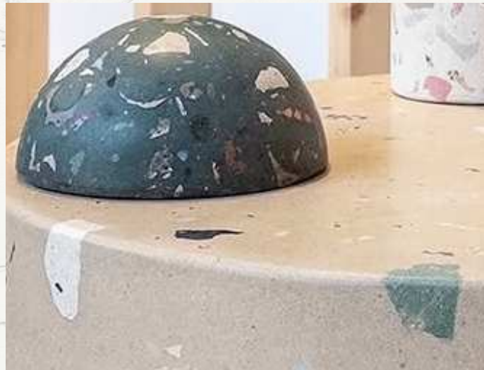
Eksempel på Urban mining elementer i fiberbeton
