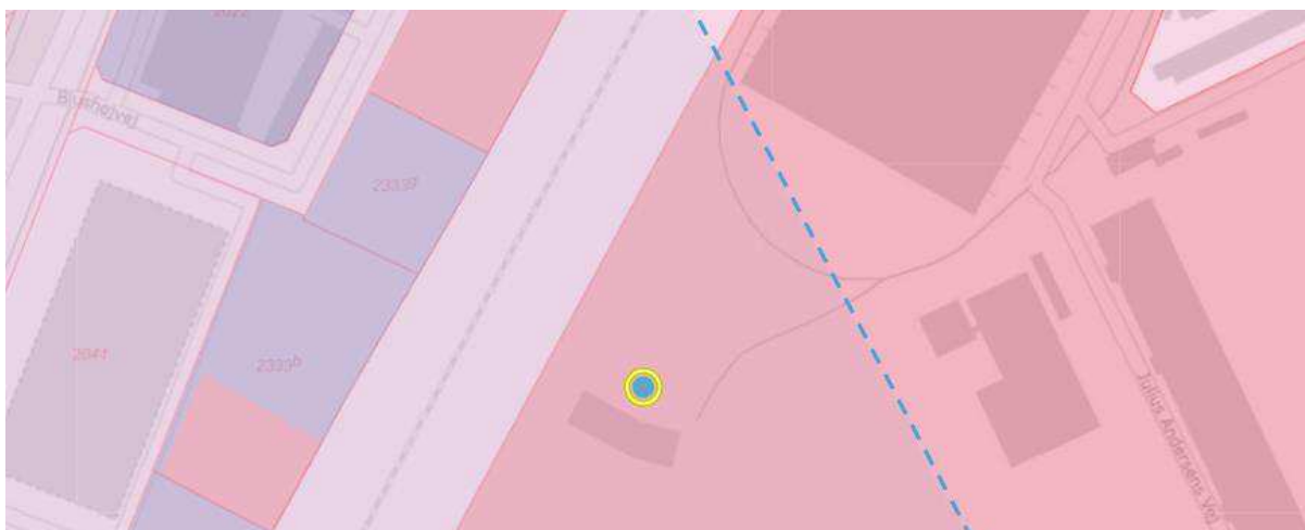
Figur 9 – Den blå farve viser V1-kortlægning, den røde farve viser V2-kortlægning, den lyserøde viser områdeklassificering og den blåstiplede linje viser afgrænsningen af område med drikkevandsinteresser (vest for linjen).
