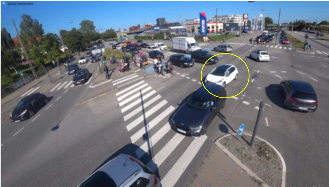
Figur 1 - Kaos i krydset, grundet ligeudkørende biler fra Ellebjergvej, der blokerede de venstresvingende fra Folehaven, som så blokerede for de ligeudkørende bilister, cyklister og fodgængere fra Gammel Køge Landevej nord
