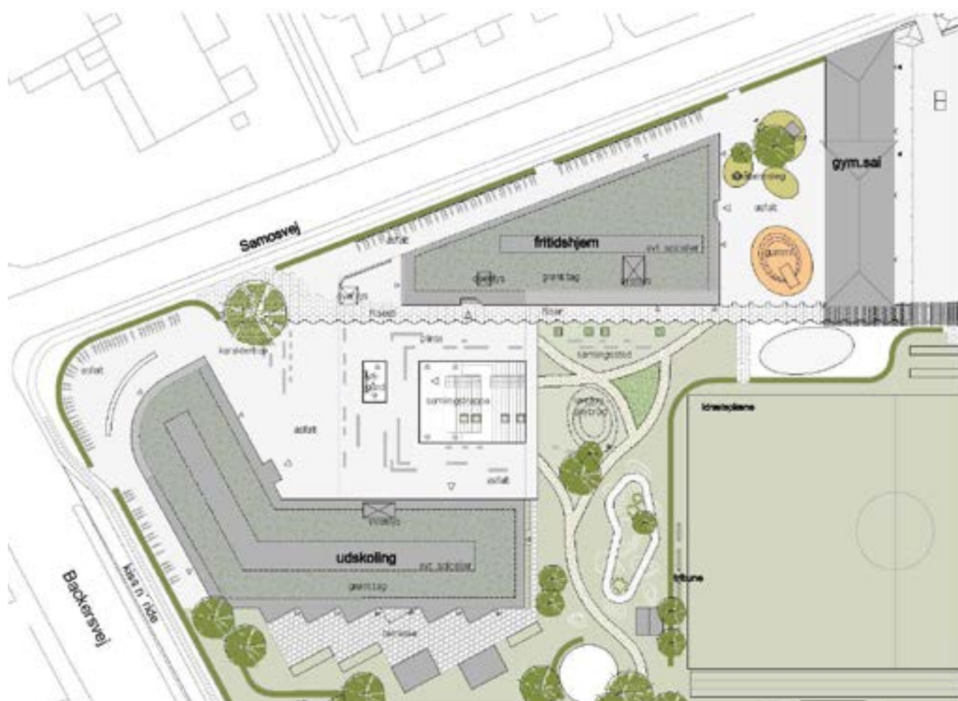
Udsnit af situationsplan, der viser placeringen af de nye byggefelt mod hjørnet Backersvej og Samosvej og den centrale trappe. Ved Backersvej ses en planlagt kiss' n' ride helle, der skal muliggøre afsætning morgen og eftermiddag. Illustration: GHB Landskab.
