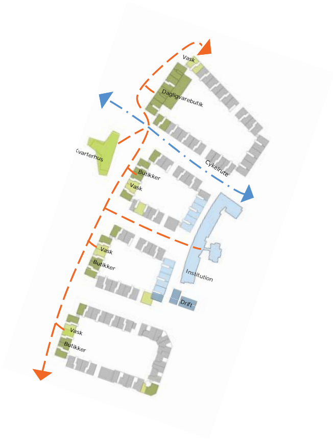
PLANDIAGRAM FOR STUEETAGE: Handelsgaden lang med Mimersparken understøttes med udlæg af butikksareal og udadvendte fællesfunktioner i stueetager og i nyt kvartershus.
