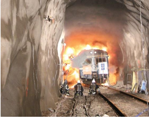
Fuldskala forsøg. Afbrænding af metrotog i Arvika, Sverige 2011
